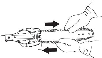
При установке новой цепи следует часто проверять ее натяжение, пока цепь не приработается. Регулярно проверяйте натяжение цепи. Регулярно проверяйте натяжение цепи. Правильно натянутая цепь обеспечивает высокое качество пиления и дольше служит.
