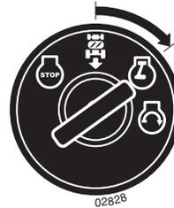
Engine "ON" (Normal användning)
