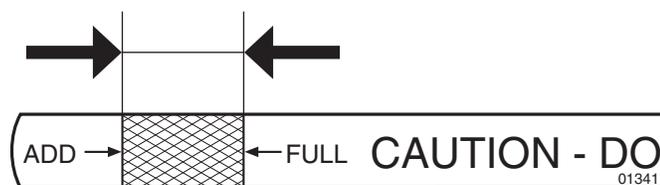
Oljenivån skall ligga mellan de båda markeringarna på stickan. Om så inte är fallet skall motorolja SAE 30 fyllas till "FULL"-markeringen. Vintertid (under fryspunkten) skall motorolja SAE 5W-30 användas.
