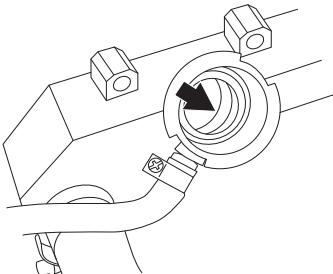
Повторное снижение уровня охлаждающей жидкости обычно свидетельствует о наличии утечки. Систему охлаждения должны проверять квалифицированные специалисты. Ограничиваться лишь добавлением охлаждающей жидкости не достаточно.
