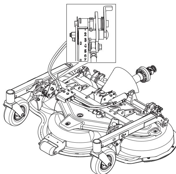
Функция подъема и опускания тяги регулировки зависит от положения гидравлических шлангов в быстроразъемных соединениях на устройстве.
