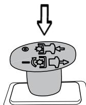
Двигатель не запустится до тех пор, пока не будет включен стояночный тормоз и подача питания на режущий блок.
