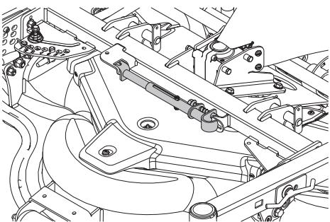
Если вы снимаете распорку в первый раз, снимите с нее предохранительный ремень и поместите его в отсек для принадлежностей под сиденьем.
