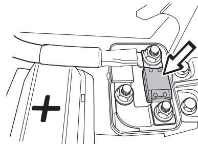
Плавкий предохранитель цепи питания для электрической соединительной коробки установлен на кронштейне рядом с аккумуляторной батареей.
