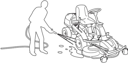
**IMPORTANTE!** Estacione sempre a máquina numa superfície nivelada com o motor **DESLIGADO** antes de qualquer tarefa de manutenção.
