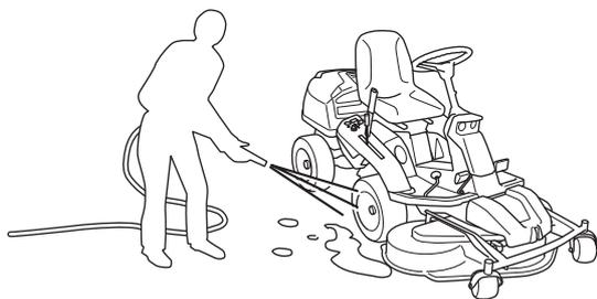
**IMPORTANT!** Garez toujours la machine sur une surface plane, le moteur coupé, avant de procéder à une opération de maintenance.
