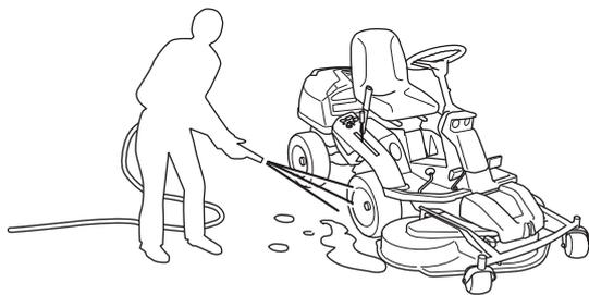
**¡IMPORTANTE!** Estacione siempre la máquina en una superficie nivelada con el motor apagado antes de realizar cualquier operación de mantenimiento.
