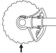
Při povolování a dotahování matice pilového kotouče může dojít k poranění rukou o zuby kotouče. Proto se snažte držet ruku při práci za krytem kotouče. Použijte vždy trubkový klíč s dostatečně dlouhou násadou, abyste toto umožnili. Šipka na obrázku ukazuje, v jakém rozmezí klíč bude pracovat při povolování nebo uťahování matice.
