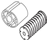
Pravidelne kontrolujte tlmiče vibrácií, či nie sú prasknuté alebo deformované. Skontrolujte, či nie je tlmič vibrácií poškodený a či je bezpečne pripevnený.
