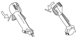
Stiskněte pojistku páčky plynu a zkontrolujte, zda se po uvolnění vrátí do své výchozí polohy.
