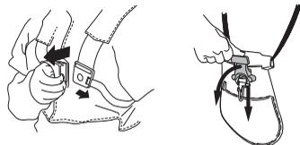
Sprawdź, czy paski szelek są właściwie umieszczone. Po wyregulowaniu szelek i zawieszania maszyny sprawdź, czy działa mechanizm rozpinania awaryjnego.
