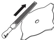
Dopilnuj, aby zęby tarczy tnącej były prawidłowo rozwarłe! Postępuj zgodnie z naszymi instrukcjami i stosuj zalecany rozwieracz. Nieprawidłowe rozwarcie zębów tarczy tnącej zwiększa ryzyko jej zakleszczenia się, odbicia oraz uszkodzenia.
