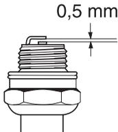
**UPOZORNENIE!** Vždy používajte odporúčaný typ zapaľovacej sviečky! Nesprávna zapaľovacia sviečka môže vážne poškodiť piest/valec. Skontrolujte, či je zapaľovacia sviečka správne nasadená.
