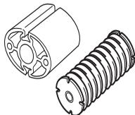
Sprawdzaj regularnie, czy elementy amortyzujące nie są pęknięte lub czy nie uległy deformacji. Sprawdź, czy elementy amortyzujące są całe i dobrze zamocowane.
