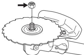
Pri upínaní utiahnite maticu v opačnom smere, ako je smer otáčania nástroja. Pri uvoľňovaní otáčajte maticu v rovnakom smere, ako je smer otáčania nástroja. (UPOZORNENIE! Matica má ľavý závit.) Pri uvoľňovaní a pri utáňovaní upínacej matice rezacieho noža vzniká riziko poranenia rezacími zubami noža. Pri takej práci preto musíte zabezpečiť, aby vaše ruky boli neustále chránené krytom noža. Vždy používajte nástrčkový kľúč z náradia. Šípky na obrázku ukazujú na miesto, kde treba
