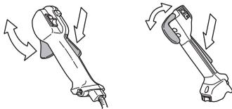
Patrz wskazówki pod rubryką Uruchamianie. Włącz maszynę i dodaj gazu do oporu. Zwolnij dźwignię gazu i sprawdź, czy
