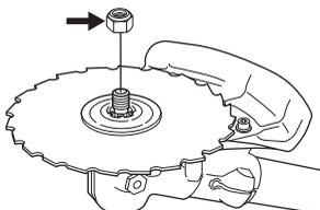
Při montáži utáhněte matici proti směru otáčení řezného vybavení. Při demontáži povolte matici ve směru otáčení řezného vybavení. (POZOR! Matice je levotočivá.) Při povolení a dotahování matice pilového kotouče může dojít k poranění rukou o zuby kotouče. Proto se snažte držet ruku při práci za krytem kotouče. Použijte vždy trubkový klíč s dostatečně dlouhou násadou, abyste toto umožnili. Šipka na obrázku ukazuje, v jakém směru klíč bude pracovat při povolování nebo utahování matice.
