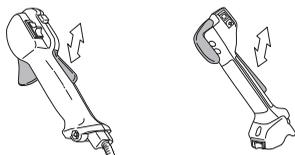
Skontrolujte, či sa páčka plynu a poistná páčka plynu voľne pohybujú a či vratné pružiny náležite fungujú.
