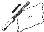
Udržujte řezací kotouč správně natočený! Sledujte naše instrukce a používejte doporučený nástroj k natočení.
