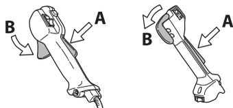
Presvedčte sa, či je ovládanie plynu zablokované pri nastavení na voľnobeh, keď je poistná páčka plynu uvoľnená.
