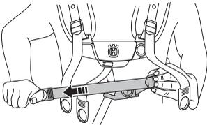
Wyreguluj wysokość haka do podwieszania zgodnie z instrukcją. (Do oczyszczania lasu zawieszenie powinno zwisać około 10 cm poniżej kości biodrowej.)
