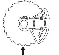
Podczas odkręcania i przykręcania nakrętki ostrza tnącego zawsze istnieje ryzyko skażenia się o zęby ostrza tnącego. Należy zatem pamiętać, aby podczas wykonywania tej czynności ręka osłonięta była przez osłonę ostrza. Aby było to możliwe, używaj zawsze klucza nasadowego z rękojeścią o odpowiedniej długości. Strzałka na rysunku wskazuje obszar, w którym należy operować kluczem nasadowym przy odpowiednio odkręcaniu i dokręcaniu nakrętki.
