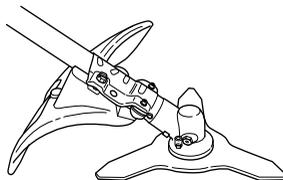
Sprawdź, czy osłona nie jest uszkodzona i czy nie ma śladów pęknięcia. Wymień osłonę, która została uderzona lub jest pęknięta.
