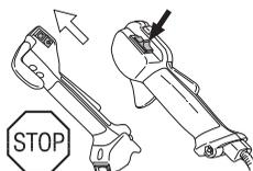
Włącz silnik i sprawdź, czy po przesunięciu wyłącznika w położenie stop silnik zatrzyma się.
