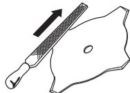
Udržiavajte správny tvar (rozvádzanie) zubov noža! Postupujte podľa našich inštrukcií a používajte odporúčané náradie na vytváranie rozvádzania zubov („šranku“). Akékoľvek nesprávne urobené rozvádzanie zubov pilového kotúča
