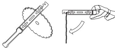
Skontrolujte rezací kotúč, či na ňom nie sú viditeľné známky poškodenia alebo trhliny. Poškodený rezací nástroj treba vždy vymeniť.
