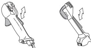
Zkontrolujte, zda se páčka plynu a její pojistka volně pohybují a zda jejich vratné pružiny fungují správně.
