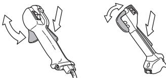
Lásd az Indítás című fejezetet. Kapcsolja be a gépet és adjon teljes gázt. Engedje el a gázsabályozót és győződjön meg róla, hogy a vágófelszerelés leállt és teljesen mozdulatlan. Ha a vágószerszám alapjáratban is forog, ellenőrizze a porlasztó
