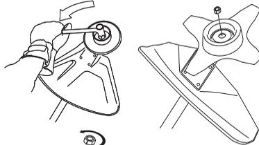
Nylonowy pierścień zabezpieczający nakrętkę przed odłączeniem się nie powinien być starty do tego stopnia, aby można było przykręcić nakrętkę ręcznie. Zabezpieczenie to powinno wymagać siły przykręcania równej co najmniej 1,5 Nm. Po około dziesięciokrotnym przykręcaniu nakrętki należy wymienić ją na nową.
