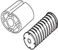
Reguliariai tikrinkite antivibracinės sistemos detales: jos turi būti nepažeistos ir nedeformuotos. Patikrinkite, ar antivibracinės sistemos detalės yra sveikos ir gerai pritvirtintos.
