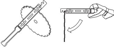
Die Schneidrüstung auf Beschädigung und Risse kontrollieren. Beschädigte Schneidrüstungen sind grundsätzlich auszutauschen.
