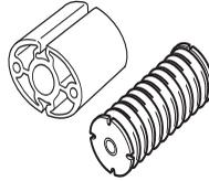
Die Antivibrationselemente regelmäßig auf Risse und Verformungen überprüfen. Kontrollieren, ob die Vibrationsdämpfer unbeschädigt und fest verankert sind.
