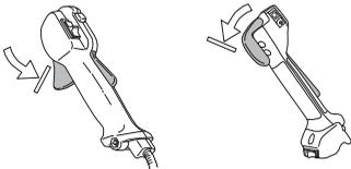
Die Gashebelsperre eindrücken und kontrollieren, ob sie in die Ausgangsstellung zurückkehrt, wenn sie losgelassen wird.
