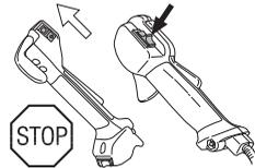
Den Motor starten und kontrollieren, ob der Motor stoppt, wenn der Stopschalter in Stopstellung geführt wird.
