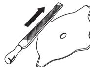
Die korrekte Schränkung der Sägeklinge beibehalten! Befolgen Sie unsere Anweisungen und verwenden Sie das empfohlene Schränkwerkzeug. Eine
