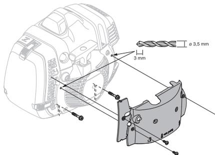
**POMEMBNO!** Stroj **MORATE** povrniti nazaj v standardno zgradbo, ko so temperature večje od 5°C . V nasprotnem primeru obstaja nevarnost pregrevanja, ki lahko resno poškoduje motor.
