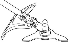
Den Schutz auf Schäden und Risse kontrollieren. Den Schutz austauschen, wenn er Schlägen ausgesetzt war oder Risse aufweist.
