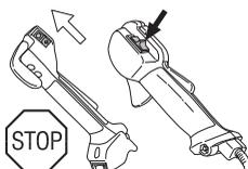
Vžgite motor in preverite, če se ustavi, ko izklopno stikalo potisnete v položaj STOP.
