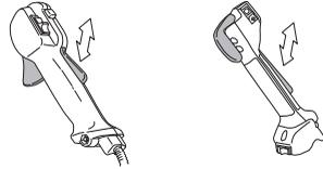
Kontrollieren, ob Gashebel und Gashebelsperre mit dem dazugehörigen Rückzugfedersystem leicht funktionieren.
