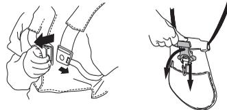
Kontrollieren, ob die Riemen des Tragegurts richtig liegen. Wenn Tragegurt und Gerät angepasst sind, kontrollieren, ob der Schnellverschluss des Tragegurts funktioniert.
