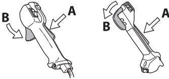
Kontrollieren, ob der Gashebel in Leerlaufstellung gesichert ist, wenn sich die Gashebelsperre in Ausgangsstellung befindet.
