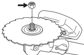
Pri montaži priključkov zategnite matico v nasprotni smeri rotacije rezilnih priključkov. Pri demontaži rezilnih priključkov zrahljate matico v smeri vrtenja. (POZOR! Matica ima levi navoj.) Ko privijate, oziroma odvijate matico na žaginem listu,
