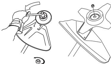
Matični nylonski zatič ne sme biti tako izrabljen, da ga je mogoče odviti s prsti. Navoj mora zdržati najmanj 1,5 Nm. Matico po desetkratni uporabi zamenjajte.
