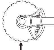
Beim Lösen und Anziehen der Sägeklingenmutter besteht die Gefahr, dass man sich an den Zähnen der Sägeklinge verletzt. Daher darauf achten, dass die Hand bei dieser Arbeit durch den Klingenschutz geschützt ist. Immer einen Hülsenschlüssel mit ausreichend langem Schaft verwenden, damit dies möglich ist. Der Pfeil in der Abbildung zeigt, in welchem Bereich der Hülsenschlüssel beim Lösen bzw. Anziehen der Mutter arbeiten soll.
