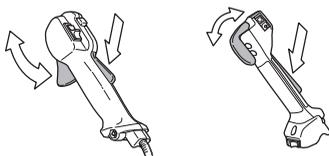
Glej poglavje pod naslovom Vžig. Vžgite stroj in mu dajte polni plin. Izpustite plinsko ročico in se prepričajte, da se rezilni priključek ustavi in obmiruje. Če se rezilni priključek vrti, ko je
