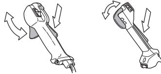
Siehe die Anweisungen unter der Überschrift Start. Gerät starten und Vollgas geben. Den Gashebel loslassen und kontrollieren, ob die Schneidausrüstung völlig zum Stillstand kommt. Wenn die Schneidausrüstung rotiert, während sich der Gashebel in Leerlaufstellung befindet, ist die LeerlaufEinstellung des Vergasers zu kontrollieren. Siehe die Anweisungen unter der Überschrift Wartung.
