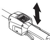
Kontrollera att gasreglaget och gasreglagespärren går lätt samt att deras returfjädersystem fungerar.
