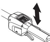
Tarkasta, että käyttöliipaisin ja sen varmistin liikkuvat vapaasti ja että niiden palautusjärjestelmät toimivat.
