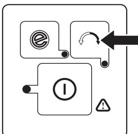
När rotationsknappen trycks in tänds den gröna dioden och trimmerhuvudet roterar moturs. Trimmerhuvudet roterar alltid medurs som förvalt (grön diod är släckt). Det är enklast att mata ut trimmerlinan när trimmerhuvudet roterar medurs.
