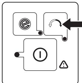
Når du trykker på rotationsknappen, lyser den grønne LED, og trimmerhovedet roterer imod urets retning. Trimmerhovedet roterer som standard altid med uret (den grønne LED er slukket).
