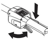
Se anvisningerne under overskriften Start. Start maskinen, og giv fuld gas. Slip strømudløseren, og kontrollér, at skæreudstyret standser, og at det forbliver i stilstand.
