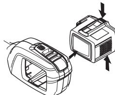
**VIGTIG!** Fjern alltid batteriet for å hindre at maskinen startes ved et uhell.
