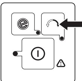
Når rotasjonsknappen trykkes, tennes den grønne dioden og trimmerhodet roterer mot urviseren. Trimmerhodet roterer alltid med urviseren som standard (den grønne dioden er slukket).
