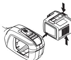
**VIGTIGT!** Batteriet skal altid udtages for at forhindre, at maskinen starter ulykkesfarligt.
