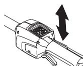
Kontroller at effektregulatoren og effektregulatorsperren går lett og at returfjæren fungerer som den skal.
