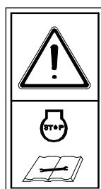
Couper le moteur avant d'effectuer des mesures de maintenance, de nettoyage et des réparations.
