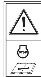
Sluk motoren, før der udføres vedlige-holdelse, rengøring eller reparation.
