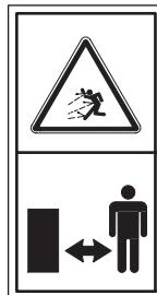
Ophold dig ikke i maskinens arbejdsmønster. Kontrollér, at det areal, der skal klip-pes, er fri for sten, kviste og andre genstande, der kan kastes ud og forårsage skader på personer eller maskinen.
