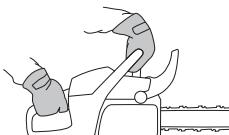
Dodajte puni gas i aktivirajte kočnicu za lanac tako da nagnete zglobov na ruci prema naprijed prema prednjem štitu za ruku. Nemojte ispuštiti prednju ručku. **Lanac bi se trebao odmah zaustaviti.**
