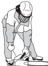
**PAŽNJA!** Nemojte ispuštiti ručicu za paljenje nakon što ste je potpuno izvukli van jer to može ošteti stroj.
