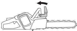
Відгиніть гайку шини і зніміть кожух зубчастого колеса. Зніміть запобіжник для транспортування (A).
