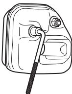
Kui seadmel on summuti, mis on varustatud sädemepüüdjaga, peab ka seda ühtlaste ajavahemike järel puhastama. Saastunud võrguga sädemepüüja töttu võib mootor üle kuumeneda ja katki minna.
