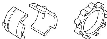
Reguliariai tikrinkite antivibracinių sistemų detales: jos turi būti nepažeistos ir nedeformuotos. Patikrinkite, ar antivibracinių sistemų detalės yra sveikos ir gerai pritvirtintos.
