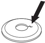
Переконайтеся, що фіксуюча гайка не втратила свого зусилля. Фіксуюча сила гайки повинна становити принаймні 1,5 Нм. Гайку слід затягнути з силою 35-50 Нм.
