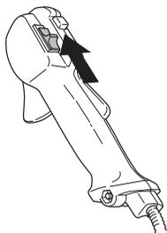
Mettere in moto e controllare che il motore si spenga portando l'interruttore in posizione di arresto.
