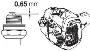
**N.B!** Usare candele originali o di tipo raccomandato! Altre candele possono danneggiare cilindro e pistone. Controllare che la candela sia munita di dispositivo di soppressione interferenze radio.
