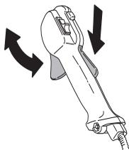
Vedi istruzioni alla voce Avviamento. Avviare il motore ed accelerare a pieno gas. Lasciar andare l'acceleratore e accertarsi che il gruppo di taglio si fermi e resti fermo. Se il gruppo di taglio ruota mentre l'acceleratore è al minimo è necessario controllare la registrazione del minimo sul carburatore. Vedi istruzioni alla voce Manutenzione.
