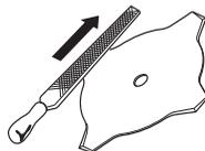
Accertarsi che la lama sia sempre correttamente registrata! Seguire le nostre istruzioni e usare gli attrezzi consigliati per la registrazione. Se la lama è registrata in modo errato aumenta il rischio di bloccaggio e contraccolpo oltre al rischio di danni alla lama stessa.
