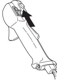
**N.B!** Il contatto di arresto torna automaticamente in posizione di avviamento. Prevenire l'avviamento involontario staccando sempre il cappuccio dalla candela prima di effettuare operazioni di montaggio, controllo e/o manutenzione.
