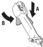
Controllare che l'acceleratore sia bloccato sul minimo quando il fermo è in posizione di riposo.
