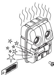
**UPOZORNENIE!** Nikdy nepoužívajte stroj, ktorý má chybny tlmič výfuku.
