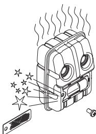
**FIGYELEM!** Ne üzemeltesse a gépet hibás hangfogóval.
