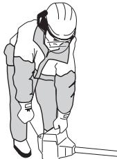
**UPOZORNENIE!** Nevstupujte žiadou časťou tela do vyznačeného priestoru. Kontakt môže mať za následok popálenie pokožky alebo elektrický šok, ak je kryt zapáľovacej sviečky poškodený. Vždy používajte rukavice. Nepoužívajte stroj s poškodeným krytom zapáľovacej sviečky.
