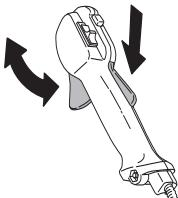
Δείτε τις οδηγίες του κεφαλαίου Εκκίνηση. Βάλτε σε λειτουργία το μηχανήμα και χρησιμοποιήστε πλήρες γκάζι. Αφήστε το γκάζι και ελέγχετε εάν το εξάρτημα κοπής σταματάει και παραμένει ακινητοποιημένο. Εάν
