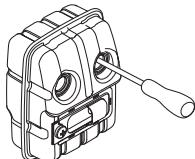
Εάν ο σιγαστήρας του μηχανήματος σας έχει και διχτυωτό φίλτρο σπινθήρων, θα πρέπει να το καθαρίζετε τακτικά. Ενα γεμάτο ακαθαροίες φίλτρο σπινθήρων προκαλεί υπερθέρμανση του κινητήρα, κάτι που μπορεί να καταλήξει σε σοδαρή θλάβη.
