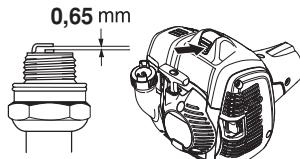
**ΠΡΟΣΟΧΗ!** Χρησιμοποιείτε πάντοτε τον τύπο μπουζιού που συστήνεται! Λάθος τύπος μπορεί να προκαλέσει ζημιά στο έμβολο/κύλινδρο. Ελέγξτε αν το μπουζί είναι εφοδιασμένο με συμπιεστή.
