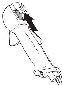
**ΠΡΟΣΟΧΗ!** Ο διακόπτης στοπ επιανέρχεται αυτόματα στη θέση εκκίνησης. Για να αποφύγετε ακούσια εκκίνηση του κινητήρα, πρέπει πάντοτε να βγάζετε το κάλυμμα του μπουζιού κατά τη συναρμολόγηση το έλεγχο ή/και τη συντήρηση.
