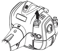
Αφαιρέστε το κάλυμμα του φίλτρου αέρα και βγάλτε έξω το φίλτρο. Ξεπλύνετε με καθαρό, ζεστό σαπουνόνερο. Καθαρίστε επίσης το εσωτερικό του καλύμματος φίλτρου χρησιμοποιώντας αέρα ή βούρτσα. Βεβαιωθείτε ότι το φίλτρο είναι στεγνό πριν το επανατοποθετήσετε.
