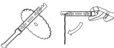
Ελέγχετε το εξαρτήμα κοπής για ζημίες ή εμφάνιση ραγισμάτων. Το κατεστραμμένο εξαρτήμα κοπής πρέπει πάντα να αντικαθίσταται.
