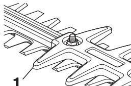
Sprawdź, czy osłona noży nie jest uszkodzona lub zdeformowana. Wymień zespół tnący, jeśli jest wykrzywiony lub uszkodzony. Termin "narzędzie elektryczne" w ostrzeżeniu dotyczy Twojego narzędzia napędzanego prądem z sieci elektrycznej ( z przewodem) lub narzędzia napędzanego przez energię baterii (bezprzewodowe).
