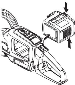
**WAŻNE!** Zawsze wyjmuj akumulator, aby zabezpieczyć maszynę przed przypadkowym uruchomieniem.
