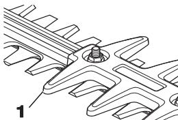
Ellenőrizze, hogy nem sérült vagy görbe-e a pengevédő. Ha a vágóegység görbült vagy sérült, cserélje ki. A "szerszám" kifejezés a figyelmeztetésekben a hálózatról működő (vezetékes) szerszámról vagy az akkumulátorról (vezeték nélküli) működő szerszámról vonatkozik.
