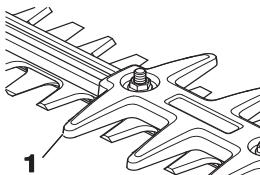
Skontrolujte, či nie je ochrana kotúča poškodená alebo zdeformovaná. Ak je rezné zariadenie ohnuté alebo poškodené, vymeňte ho. Výraz „elektrický nástroj“ v upozorneniach označuje elektrické nástroje napájané z elektrickej siete (s káblom) alebo napájané z batérie (bez kábla).
