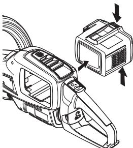
**UPOZORNĚNÍ!** Aby nemohlo dojít k nechtěnému spuštění stroje, vždy vyjmějte baterii.
