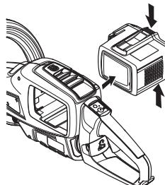
**FONTOS!** Mindig vegye ki az akkumulátort annak biztosítására, hogy a gép ne indulhasson be véletlenül.
