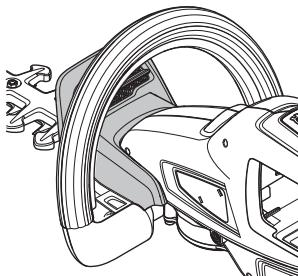
Sprawdź, czy osłona ręki jest dobrze zamocowana. Sprawdź, czy osłona ręki nie jest uszkodzona.
