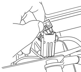
Verwenden Sie beim Ersetzen keinen anderen Sicherungstyp.
