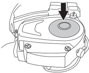
Luftleitweg auf der Unterseite der Motorhaube überprüfen, er muss sauber sein und darf nicht am Kühlluftinlass schaben.
