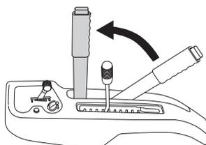
Wird der Sperrknopf gedrückt und der Hebel nach vorne geführt, senkt sich das Schneidwerk, und die Messer beginnen automatisch zu rotieren (Mähstellung).
