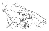
8 Desserrer le ressort qui tend la courroie et décrocher celle-ci.
