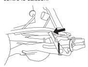
4 Insérez la courroie dans le support de courroie.
