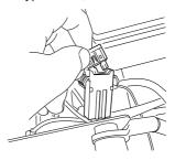
N'utilisez aucun autre type de fusible en cas de remplacement.
