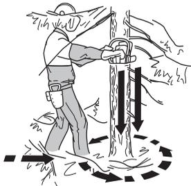
Uklonite bilje koje se nalazi ispod debla i provjerite ima li kamenja, grana, rupa itd koji bi Vam smetali. Svrha toga je da kad drvo počne padati, Vi možete lako odstupiti. Vaš put odstupanja trebao bi se nalaziti otprilike 135° iza planiranog pada drveta
