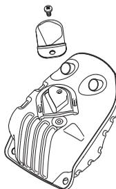
Prigušivač je napravljen da bi smanjio buku i udaljio ispušne plinove od korisnika pile. Ispušni plinovi su vrući i mogu sadržavati iskre koje mogu započeti vatru ako su usmjerene prema suhom i zapaljivom materijalu.
