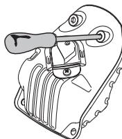
Neki prigušivači su opremljeni s specijalnom zaštitnom mrežicom. Ukoliko Vaš stroj ima takvu vrstu prigušivača, onda morate očistiti tu zaštitnu mrežicu barem jednom tjedno. To možete učiniti sa čeličnom četkom. Blokirana mreža može prouzročiti pregrijavanje motora i ozbiljna oštećenja.
