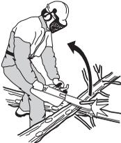
Morate imati nadzor nad predmetom rada. Kada su dijelovi koje namjeravate rezati mali i lagani, mogu se zaglaviti u i biti izbačeni prema vama. Čak i kada niste u opasnosti, možete se iznenaditi i izgubiti nadzor nad pilom. Uvijek razdvojite poredane trupce ili grane prije rezanja. Pilite isključivo pojedinačne trupce ili komade drva. Uklonite ispiljene dijelove kako biste održali sigurnost radnog područja.
