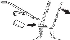
Preporučena je uporaba vodilice čija je duljina veća od promjera stabla, tako da rezove za obaranje i rezove za usmjeravanje možete načiniti "jednim potezom". Za detalje o preporučenim duljinama vodilice za vaš model motorne pile, pogledajte upute u odeljku Tehničke karakteristike.
