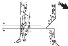
Postavi naslonjač kore (ako je takav namješten) iza pojasa lomljenja. Dodajte pun gas i polako prinesite mač i lanac drvetu. Pazite da se drvo ne počne micati u suprotnom smjeru od smjera željenog obaranja. Zabijte klin ili polugu u rez čim rez postane dovoljno dubok.
