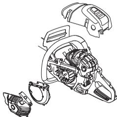
Jednom tjedno očistite rashladni sistem četkom, a ako su radni uvjeti teški i češće. Prljav ili začepljen rashladni sistem uzrokuje pregrijavanje stroja, a to šteti klipnu i cilindru.
