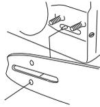
Zategnite lanac koristeći se kombi ključem. Okrenite vijak za podešavanje mača u smjeru kazaljke na satu. Lanac treba zatezati dok ne prestane visiti na donjoj strani mača. Pogledajte upute u odjeljku Zatezanje lanca.
