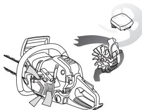
**VAŽNO!** Da biste osigurali ispravnost centrifugalnog sistema čišćenja, važno je redovno održavati i brinuti se za njega. Očistite dovod zraka u napravu za paljenje, krilca na kotaču, prostor oko kotača, ulaznu cijevčicu i prostor rasplinjača.
