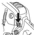
Motor zaustavite pritiskom na prekidač za pokretanje/ zaustavljanje.
