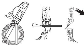
Dovršite obarajući rez paralelno sa crtom smjernog reza tako da razlika između njih bude najmanje 1/10 promjera debla. Ne prerezani dio debla se zove pojas lomljenja.
