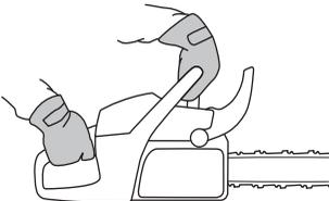
Dodajte puni gas i aktivirajte kočnicu za lanac tako da nagnete zglob na ruci prema naprijed prema prednjem štitu za ruku. Nemojte ispustiti prednju ručku. **Lanac bi se trebao odmah zaustaviti.**
