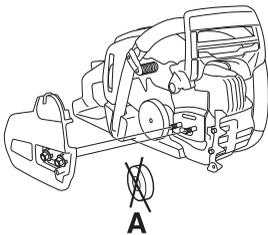
Namjestite mač preko vijaka za mač. Postavite mač u njegov najstražnji položaj. Stavite lanac preko pogonskog kotača i u urez na maču. Počnite s gornje strane mača.
