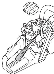
Za temperature ispod -5 °C i/ili u zimskim uvjetima (snijeg) na raspolaganju je poseban poklopac postavljen na kućište naprave za paljenje.
