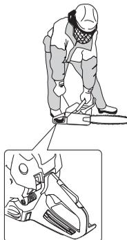
Pošto je kočnica lanca i dalje aktivirana mora se ubrzo broj obrta motora spustiti na prazan hod, što se postiže na taj način da se iskopča zapreka gasa. Sa ovim izbjegavate nepotrebno habanje kvačila, bubnja kvačila kao i kaiša za kočenje.
