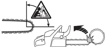
Rezanje donjom stranom mača, odnosno s vrha predmeta prema dolje, zove se rezanje povlačeći motornu pilu. U tom slučaju motorna pila će se sama povući prema drvetu, a prednji kraj tijela motorne pile će postati prirodni oslonac za vrijeme rezanja. Rezanje povlačeći pilu daje Vam bolji nadzor nad motornom pilom i položajem zone trzaja.
