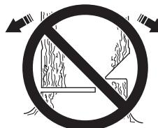
Amikor a döntőhajk és a döntővágás elkészült, a fának saját súlyától, vagy pedig a döntőék vagy a döntőemelő segítségével el kell dölnie.
