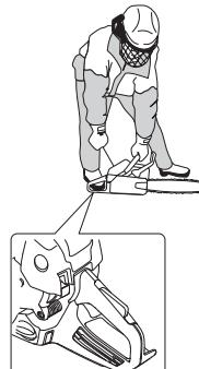
Ponieważ hamulec łańcucha nadal jest włączony, obroty silnika należy jak najszybciej zmniejszyć do obrotów biegu jałowego, co można osiągnąć wylęczając szybko blokadę gazu. W ten sposób zapobiega się nadmiernemu zużyciu sprzęgła, bębna sprzęgła oraz pasa hamulca.
