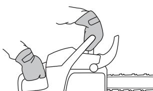
Přidejte plyn, až motorová pila dosáhne plných otáček, a uvedte v činnost brzdu řetězu tlakem levého zápeští dopředu na chránič ruky. Nepouštějte přední rukojet. **Řetěz by se měl okamžitě zastavit.**
