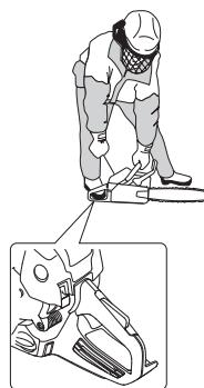
Jelikož je brzda řetězu stále ještě zapojena, je nutno co nejdříve snížit počet otáček motoru na volnoběh, čehož dosáhnete tím, že rychle vypojíte držák škrťicí klapky plynu. Tím se vyhnete zbytěčnému opotřebování spojky, bubnu spojky a brzdného pásu.
