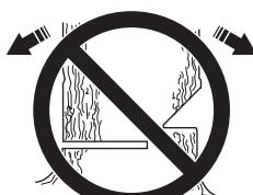
Po dokončení směrového zářezu a hlavního řezu by se strom měl začít káct samovolně nebo pomocí dřevorubeckého klínu či páčidla.
