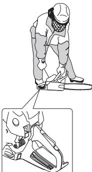
Тъй като верижната спирачка продължава да е задействана, трябва оборотите на двигателя да се приведат на празен ход, което се постига, като бързо се изключи фиксатора на дроселната клапа. Така избягвате излишно износване на съединителя, барабанът на съединителя и спирачната лента.
