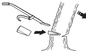
Препоръчваме ви да използвате шина, която е по-дълга от диаметъра на дървото, така че да можете да правите основния срез и насочващите срезове с "единични режещи движения". Вижте инструкциите в раздела със заглавието Технически данни относно кои дължини на шината се препоръчват за вашия модел моторен трион.
