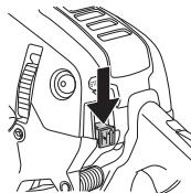
**ЗАБЕЛЕЖКА!** Ключът за пускане и спиране автоматично се връща на работно положение. За да се избегне непреднамерено стартиране, капачката на запалителната свещ трябва да се сваля от свещта при монтаж, проверка и/или изпълняване на техническо обслужване и поддръжка.
