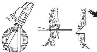
Поваляният срез трябва да завърши успоредно на линията на направляващия срез, като разстоянието помежду им трябва да бъде най-малко 1/10 от диаметъра на стъблото. Несязаната част на дървото се нарича предпазна ивица.
