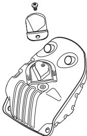
Ауспухът е предназначен за намаляване равнището на шума и насочване на отработените газове встризи от оператора. Отработените газове са нагрети и могат да съдържат искри, които да предизвикат пожар, като попаднат върху сух и горлив материал.
