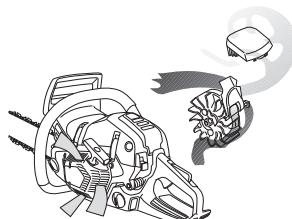
**ЗАПОМНЕТЕ!** За да действа центробежното почистване е необходимо да се провежда редовна поддръжка. Почистете устройството за засмукване на въздуха в стартера, перките на вентилатора на маховика, пространството около маховика, входната тръбичка и пространството на карбуратора.
