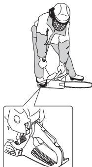
Якщо ланцюгове гальмо ще активоване, треба перевести двигун в роботу на холостому ході якомога швидко, це робиться за допомогою фікатора дроселя. Це допоможе уникнути непотрібному зносу зчеплення, барабана зчеплення й гальмової стрічки.
