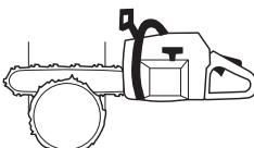
Існують декілька методів зрізування дерев із діаметром більше, чим довжина направляючої шини. Однак ці методи більш ризиковані, тому що зона віддачі направляючої шини буде контактувати з деревом.
