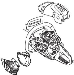
Rashladni uređaj čisti četkom jednom nedeljno, a po potrebi i češće. Priljav ili začepljen rashladni uređaj dovodi do pregrevanja mašine i oštećenja klipa i cilindra.
