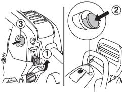
Uхватite prednju ručku levom rukom. Stavite desno stopalo na mesto za čizmu na donjem delu zadnje ručke pritiskajući mašinu ka tlu.
