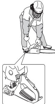
Pošto je kočnica lanca i dalje aktivirana mora se ubrzo broj obrta motora smanjiti na prazan hod, što se postiže na taj način da se iskopča zapreka gasa. Sa ovim izbegavaš nepotrebno habanje kvačila, bubnja kvačila kao i kaiša za kočenje.
