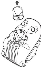
Prigušivač je zamišljen da smanji buku i usmeri izduvne gasove daleko od rukovoaca. Izduvni gasovi su vrel i u njima zna da bude varnica, što može da izazove požar ako su gasovi usmereni na suv i zapaljiv materijal.
