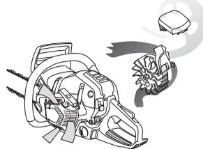
**VAŽNO!** Za trajno funkcionisanje centrifugalnog čišćenja potrebno je su stalno održavanje i briga. Očisti ulaz vazduha u starter, elise zamajca, prostor oko zamajca, ulaznu cev i karburatorski prostor.
