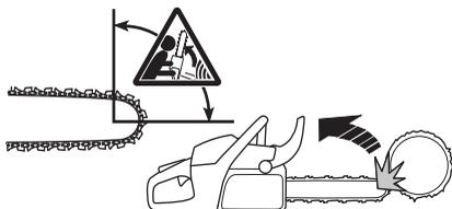
Lančana testera uvek odskae u ravni sečenja. Lančana testera i mač obično odskaku unatrag i nagore u pravcu rukovaoca. Ipak, lančana testera može da odskoči i u drugom smeru zavisno od načina na koji je upotrebljavana u trenutku kada je zona odskoka na maču dotakla predmet.
