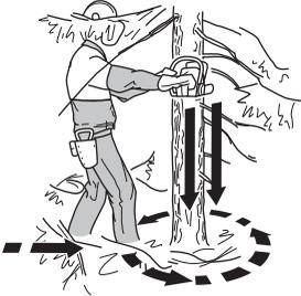
Odstrani svu vegetaciju oko drveta i proverii da u okolini nema prepreka (kamenja, grana, rupa itd.) da bi se mogao nesmetano udaljiti kad drvo počne da pada. Treba da se povlačiš ukoso za otprilike 135° od nameravanog pravca pada stabla.
