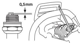
Beleška! Uvek upotrebjavaj preporučeni tip svećice! Pogrešna svećica može da dovede do teškog oštećenja klipa/cilindra. Proveri da svećica ima tkz. zaštitu protiv radio valova.
