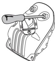
Neki prigušivači opremljeni su specijalnom mrežom. Ako tvoja mašina ima takav prigušivač treba mrežu čistiti bar jednom nedeljno, što se radi žičanom četkom. Blokirana mreža izazvaće pregrevanje mašine i može da dovede do ozbiljnih oštećenja.
