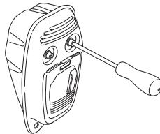
Se a sua máquina estiver equipada com um abafador de chamas, este deverá ser submetido a uma limpeza
