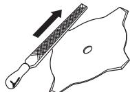
Verifique se o equipamento de corte está danificado ou com rachaduras. Um equipamento de corte danificado deve sempre ser substituído.
