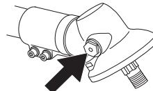
A massa lubrificante da caixa de engrenagens normalmente não necessita de ser substituída, a não ser no caso de eventuais reparações.
