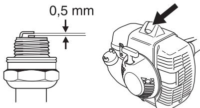
**NOTA!** Use sempre o tipo de vela de ignição recomendado! Uma vela de ignição incorrecta pode danificar o pistão/cilindro. Verifique se a vela de ignição não produz interferências de rádio.
