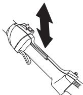
Verifique se o acelerador e o bloqueio do acelerador funcionam com facilidade e se os seus respectivos sistemas de mola de retorno funcionam.
