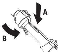
Verifique se o acelerador está fixo na posição marcha em vazio quando o bloqueio de acelerador estiver na sua posição original.
