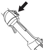
**NOTA!** O contacto de paragem retorna automaticamente à posição de arranque. Por isso, para impedir o arranque acidental da máquina, deve-se sempre remover a protecção da vela de ignição durante todos os trabalhos de montagem, inspecção e/ou manutenção.
