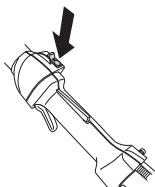
Arranque o motor e verifique se este se desliga quando o contacto de paragem é levado à posição de paragem.
