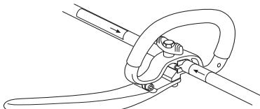
**¡ATENCIÓN!** Al montar el mango J, deben utilizarse únicamente hojas/cuchillas para hierba o cabezal de corte/cuchillas de plástico. No utilizar nunca la hoja de sierra con el mango J.
