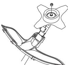
Para el montaje, apriete la tuerca girándola en sentido contrario al sentido de rotación del equipo de corte. Para el desmontaje, afloje la tuerca girándola en el sentido de rotación del equipo de corte. (NOTA: La tuerca tiene rosca
