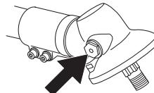
Generalmente, el lubricante en el cuerpo del engranaje no requiere cambiarse excepto cuando se realizan reparaciones.
