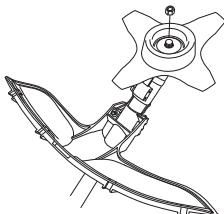
Ao montar, aperte a porca no sentido oposto ao sentido de rotação do equipamento de corte. Para desmontar, desaperte a porca no sentido da rotação do equipamento
