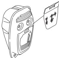
**¡NOTA!** No utilice nunca la máquina con un silenciador en mal estado.
