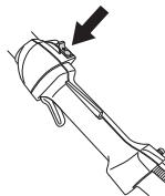
**¡NOTA!** El contacto de parada retorna automáticamente a la posición de arranque. Por consiguiente, antes de realizar trabajos de montaje, control y/o mantenimiento se debe quitar el capuchón de encendido de la bujía para evitar el arranque imprevisto.
