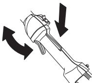
Consulte las instrucciones bajo el título Arranque. Ponga en marcha la máquina y acelere al máximo. Suelte el acelerador y controle que el equipo de corte se detenga y permanezca inmóvil. Si el equipo de corte gira con el acelerador en ralentí, se debe controlar la regulación del carburador para ralentí. Consulte las instrucciones bajo el título Mantenimiento.
