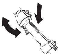
Вижте инструкциите в раздел Стартиране. Стартирайте устройството и подайте пълна газ. Отпуснете регулатора на газ и се убедете, че режещото оборудване спира и остава неподвижно. Ако след като поставите подаването на газта на празен ход, режещото оборудване продължава да се върти, трябва да се провери регулировката на празния ход на
