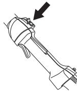
**ВНИМАНИЕ!** Изключвателят автоматично се връща на първоначалното си положение. За да предотвратите неумишлено запалване капачката на свещта трябва да бъде отстранена от свещта при монтиране, проверка и/или провеждане на техническа поддръжка.
