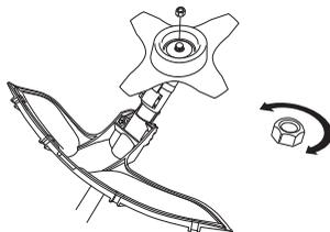
Найлоновото застопоряване на контрагайката не бива да бъде износено до степен, че да може да се върти с пръсти. Застопоряването трябва да издържа поне на усилие равно на 1,5 Nm. Гайката трябва да се смени след като е завинтана около 10 пъти.
