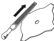
Проверявайте режещото оборудване за повреди и образували се пукнатини. Повредено режещо оборудване подлежи винаги на подмяна.
