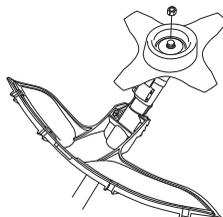
При монтирането гайката следва да се затяга в обратната посока на въртенето на режещото оборудване. При демониране гайката следва да се отвинтва по посока на въртенето на режещото оборудване. (ЗАБЕЛЕЖКА! Гайката има левоходова резба.) Затегнете гайката с глухия ключ.
