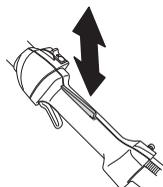
Убедете се, че пусковият механизъм и фиксаторът на дроселната клапа се движат свободно и възвратните пружини са в изправност.
