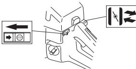
Use o mesmo procedimento que para o motor frio mas sem accionar o estrangulador. A posição de aceleração de arranque obtém-se ao accionar o estrangulador e retorná-lo à posição original.
