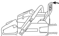
Rearme o travão da corrente levando a protecção contra o retrocesso em direcção ao arco dos punhos. A motosserra está agora pronta a ser usada.
