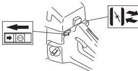
Utilice el mismo procedimiento de arranque que para el motor frío, pero no coloque el estrangulador en la posición de estrangulamiento. Para la aceleración de arranque, ponga el estrangulador en la posición de estrangulamiento y, a continuación, vuelva a empujarlo hacia dentro.
