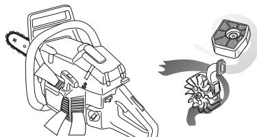
**IMPORTANTE!** Para conservar a função de purificação centrífuga, é necessário prestar assistência e manutenção contínuas. Limpe a entrada de ar do dispositivo de arranque, asas de ventoinha da cambota, compartimento em torno da cambota, tubo de admissão e compartimento do carburador.
