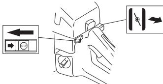
Se a máquina estiver equipada com uma válvula descompressora (A): Comprima a válvula para diminuir a pressão no cilindro, o que facilita o arranque da máquina. A válvula descompressora deve usar-se sempre no
