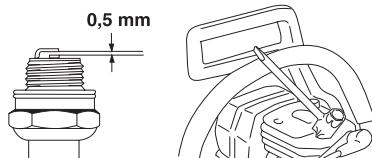
Aclaración! ¡Utilice siempre el tipo de bujía recomendado! Una bujía incorrecta puede arruinar el pistón y el cilindro. Asegúrese de que la bujía tenga supresión de perturbaciones radioeléctricas.
