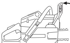
Para poner el freno de cadena en su posición inicial, mueva la protección contra reculadas hacia la empuñadura del mango. Ahora, la motosierra está lista para funcionar.
