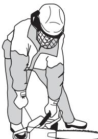
Comprima imediatamente para dentro o estrangulador quando o motor funcionar e faça renovadas tentativas até que o motor arranque. Quando o motor arrancar dê rapidamente aceleração total e a aceleração de arranque é automaticamente desligada.
