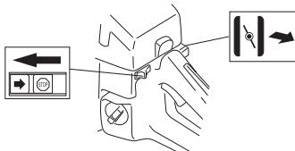
Si la máquina tiene una válvula de descompresión (A): oprima la válvula para reducir la presión en el cilindro y facilitar el arranque de la máquina. La válvula de descompresión debe utilizarse siempre para los
