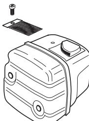
O silenciador é configurado para abafar o nível de ruído e para conduzir os gases de escape para longe do utilizador. Os gases de escape são quentes e podem conter faíscas que podem causar incêndios, se os gases forem dirigidos contra um material seco e inflamável.
