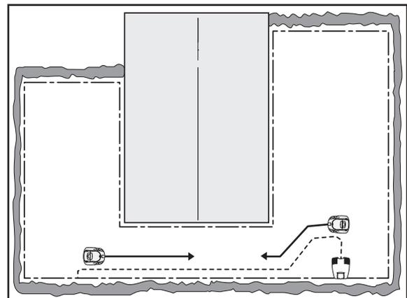
No coloque el cable en ángulos agudos. De hacerlo, el cortacésped puede tener dificultades en seguir el cable de guía.
