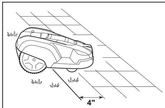
Si el área de trabajo está dividida por un sendero plano situado al mismo nivel que el césped, se puede permitir que Automower® entre un poco en el sendero. Es adecuado colocar el cable delimitador debajo de las placas. También se puede colocar en las uniones entre las placas.
