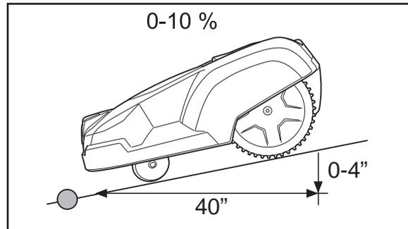
El cable delimitador no se debe colocar a través de una pendiente de inclinación superior al 10 %. De hacerlo hay riesgo de que Automower® tenga dificultades en dar la vuelta. Entonces el cortacésped se para y muestra el mensaje de fallo *Fuera área de trabajo*. El riesgo de que ello ocurra es mayor en tiempo húmedo puesto que las ruedas pueden patinar en la hierba mojada.
