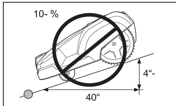
No obstante, si hay un obstáculo con el que está permitido que choque Automower®-por ejemplo una valla o un seto-, se puede colocar el cable delimitador a través de una pendiente de inclinación mayor del 10 %.
