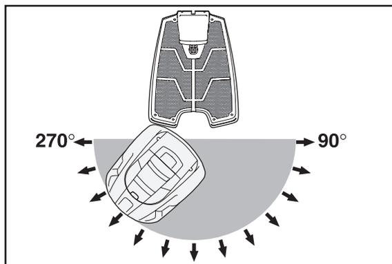
El cortacésped se puede ajustar para hasta dos sectores de salida. Si la estación de carga está situada en un pasadizo, pueden ser necesarios dos sectores de salida de, por ejemplo, 70° - 110° y 250° - 290°.
