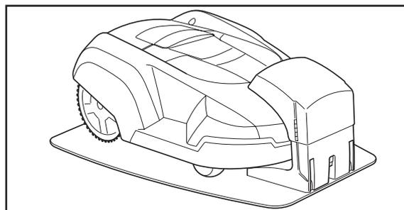
Se obtiene un buen contacto cuando ambas pletinas de carga del cortacésped tocan en el centro de las pletinas de contacto de la estación de carga.
