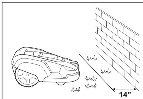
Si el área de trabajo es limítrofe con una zanja pequeña, como un macizo floral, o una protuberancia pequeña, como una piedra de bordillo (3 - 5 cm) (1" - 2"), el cable delimitador se debe colocar a 30 cm (12") dentro del área de trabajo. Así se impide que las ruedas entren en la zanja o se suban en la piedra de bordillo.
