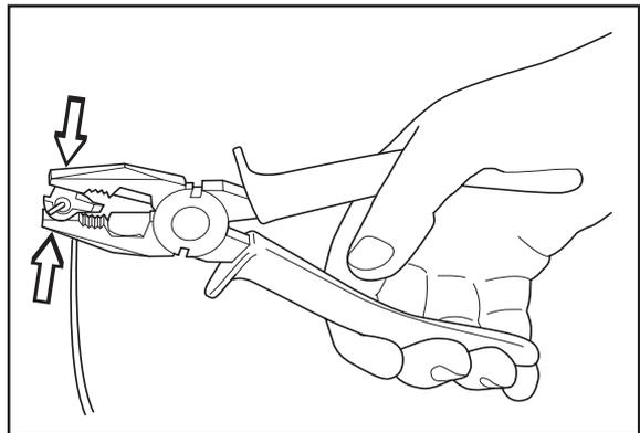
5. Corte el cable delimitador sobrante. Corte a 1 - 2 cm (0.4" - 0.8") sobre los conectores.
