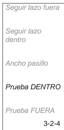
Cuando se selecciona esta función, el cortacésped sigue directamente el lazo delimitador, la guía 1 o la guía 2 (el que encuentra primero) hacia la estación de carga. Si hay un pasadizo y que el cortacésped no puede atravesar, el valor de *Ancho pasillo* es demasiado alto. Cuando está activada *Prueba DENTRO*, el cortacésped se desplaza en la distancia más grande desde el cable, permitida por el ancho de pasillo elegido.
