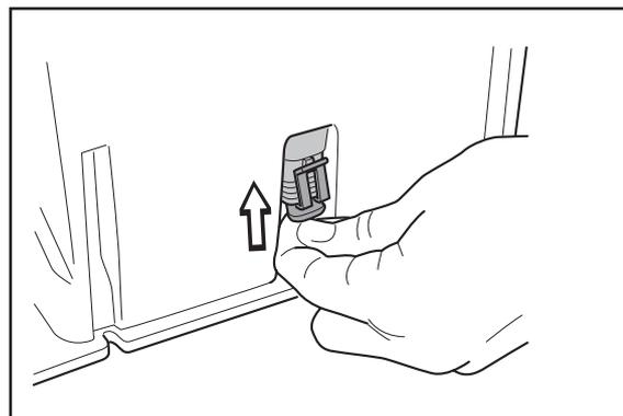
5. Conecte el cable de baja tensión en el transformador.
