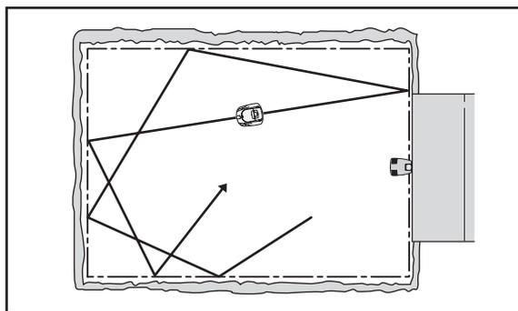
Si Automower® entra en una área en la que detecta que la hierba es más alta que antes, puede cambiar la pauta de movimiento. Entonces puede cortar en una forma rectangular para cortar de manera más sistemática la superficie con hierba más alta.
