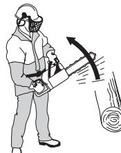
Якщо ж віддача не дуже сильна чи зона віддачі направляючої шини більше усього до
