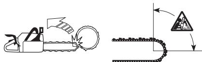
Віддача завжди виникає на ріжучій поверхні направляючої шини. Як правило ланцюгова пилка та направляюча шина відскакують уверх та убік користувача. Однак, ланцюгова пилка може рухатися й в іншу сторону в залежності від того, як вона використовувалась, коли зона
