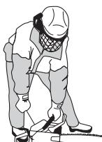
Čim motor počne da pali pritisni regulator sauga i ponavljaj pokušaje paljenja. Kad se motor upali brzo daj pun gas. Onda će se kočnica gasa otpustiti.
