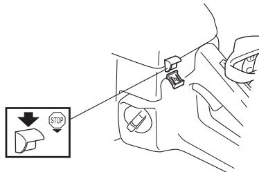
Motor se zaustavlja prebacivanjem isključnog prekidača u položaj za zaustavljanje.
