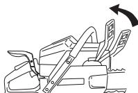
Skini maticе mača i poklopac kvačila (kočnica lanca). Skini prsten za zaštitu u transportu (A).
