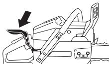
**Testeru nikada nemojte nositi ili kažiti o okidač! To bi moglo da ošteti mehanizam i onemogući korišćenje kočnice za lanac.**
