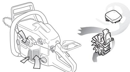
**VAŽNO!** Za trajno funkcionisanje centrifugalnog čišćenja potrebno su stalno održavanje i briga. Očisti ulaz vazduha u starter, elise zamajca, prostor oko zamajca, ulaznu cev i karburatorski prostor.
