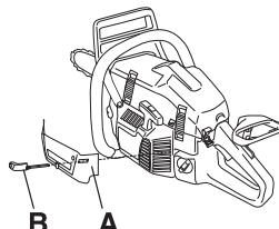
Ovi smanjuju protok vazduha za hlađenje i sprečavaju usisavanje većih količina snega u komoru karburatora.
