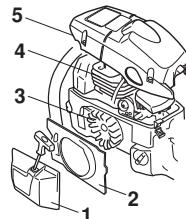
Rashladni uređaj čisti četkom jednom nedeljno, a po potrebi i češće. Prljav ili začepljen rashladni uređaj dovodi do pregrevanja mašine i oštećenja klipa i cilindra.
