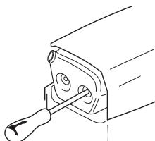
Neki prigušivači opremljeni su specijalnom mrežom. Ako twoja mašina ima takav prigušivač treba mrežu čistiti bar jednom nedeljno, što se radi žičanom četkom. Blokirana mreža izazavaće pregrevanje mašine i može da dovede do ozbiljnih oštećenja.
