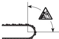
Lančana testera uvek odskače u ravni sečenja. Lančana testera i mač obično odskaču unatrag i nagore u pravcu rukovaoca. Ipak, lančana testera može da odskoči i u drugom smeru zavisno od načina na koji je upotrebljavana u trenutku kada je zona odskoka na maču dotakla predmet.
