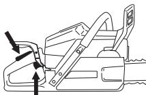
Beleška! Vrati kočnicu u prvobitno stanje na taj način da povučeš zaštitu odskoka prema podlozi rukohvata. Sa ovim je motorna testera spremna za upotrebu.
