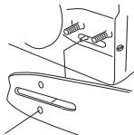
Zategni lanac pomoću kombinovanog ključa. Okreći zavrtanj za podešavanje lanca u pravcu kazaljke na satu. Lanac treba
