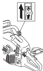
Quando o contacto é levado para cima, liga-se o aquecimento. Levando-se o contacto para baixo, desliga-se o aquecimento.
