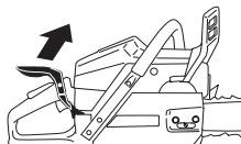
Mueva el freno de la mano derecha hacia delante/arriba para controlar que se mueve fácilmente y que está bien afianzado en su articulación en el envolvente del embrague.
