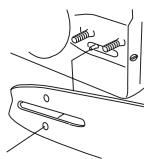
Estique a corrente, apertando com o auxílio da chave universal ou parafuso esticador da corrente, no sentido horário. Estique a corrente até que esta deixe de estar frrouxa na parte inferior da lâmina. Ver instruções na secção Esticar a corrente da serra.
