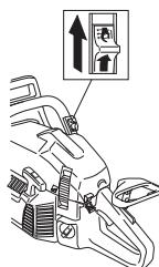
Si se empuja el interruptor hacia la arriba se pone en funcionamiento la calefacción. Si se empuja hacia abajo se apaga la calefacción.
