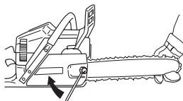
El tensado de una cadena nueva debe controlarse con frecuencia, hasta que se haya hecho el rodaje. Controle el tensado regularmente. Una cadena correcta significa buena capacidad de corte y larga duración.
