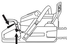
Observe! Rearme o travão da corrente levando a protecção contra o retrocesso em direcção ao arco dos punhos. A moto-serra está agora pronta a ser usada.
