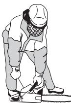
Comprima imediatamente para dentro o estrangulador quando o motor funcionar e faça novadas tentativas até que o motor arranque. Quando o motor arrancar dê rapidamente aceleração total e a aceleração de arranque é automaticamente desligada.
