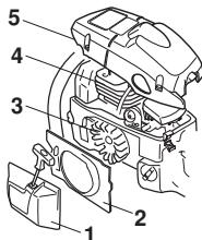
Limpie el sistema refrigerante con un cepillo una vez por semana (en condiciones difíciles, con mayor frecuencia). Un sistema refrigerante sucio u obturado produce sobrecalentamiento de la máquina, con las consiguientes averías del cilindro y el pistón.
