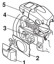
Limpe o sistema de arrefecimento com uma escova, uma vez por semana, ou com mais frequência, em condições de trabalho difíceis. O sistema de arrefecimento obstruído ou sujo conduz a um sobreaquecimento da máquina, danificando o cilindro e o pistão.
