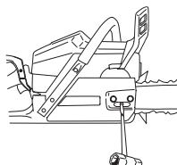
A corrente está correctamente esticada quando não mais estiver frouxa na parte inferior da lâmina e ainda possa ser girada facilmente com a mão. Aperte bem as porcas da lâmina com a chave universal ao mesmo tempo que segura a extremidade da lâmina.
