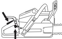
Aclaración! Para poner el freno de cadena en su posición inicial, mueva la protección contra reculadas hacia la empuñadura del mango. Ahora, la motosierra está lista para funcionar.
