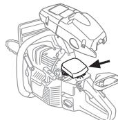
Uma limpeza mais completa obtém-se ao lavar o filtro com água e sabão.
