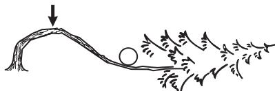
Oceni koji je najbezbedniji način da se opusti napetost i da li si ti u stanju da to bezbedno učiniš. U komplikovanim slučajevima jedini bezbedan metod je da se lančana testera ostavi na stranu i upotrebni čekrk.
