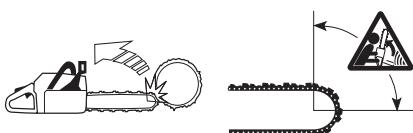
Lančana testera uvek odskaci u ravni sečenja. Lančana testera i mač obično odskakuju unatrag i nagore u pravcu rukovaoca. Ipak, lančana testera može da odskoci i u drugom
