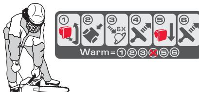
Kako je lančana kočnica još uvek aktivna, brzina motora se mora što pre podesiti na prazan hod, to se postiže otpuštanjem brave gasa. Otpuštanje se postiže blagim dodirom na komandu dovoda gasa. Sa ovim izbegavaju nepotrebno habanje kvačila, bubenja kvačila kao i kaiša za kočenje. Ostavite mašinu na praznom hodu nekoliko sekundi, pre nego što date pun gas.
