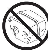
Compruebe regularmente que el silenciador esté firmemente montado en la máquina.
