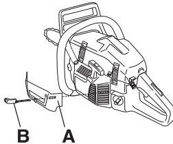
Estas medidas reduzem a entrada de ar frio e impedem a sucção de maiores quantidades de neve para o compartimento do carburador.
