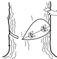
Se pierde completamente el control de la dirección de derribo del árbol si la faja de desgaje es demasiado pequeña o se atraviesa al cortar, o si los cortes de indicación y derribo están mal situados.
