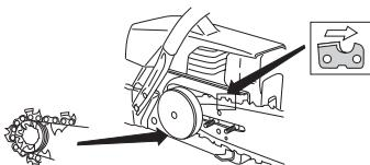
Verifique se o fio dos elos de corte está voltado para a frente, na parte superior da lâmina.
