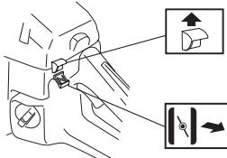
**Bomba de combustible:** Si la máquina está equipada con bomba de combustible (A): Presione varias veces la burbuja de goma de la bomba de combustible hasta que comience a llenarse de combustible. No es necesario llenarla totalmente.
