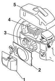
Limpe o sistema de arrefecimento com uma escova, uma vez por semana, ou com mais frequência, em condições de trabalho difíceis. O sistema de arrefecimento obstruído ou sujo conduz a um sobreaquecimento da máquina, danificando o cilindro e o pistão.
