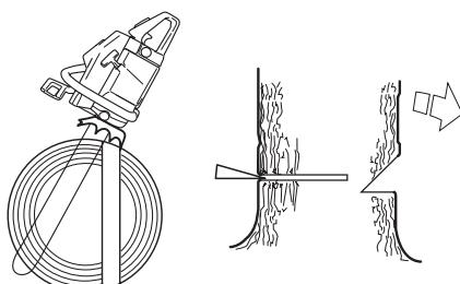
O corte de abate deverá terminar paralelamente à linha de corte direccional de modo que a distância entre ambos seja no mínimo de 1/10 do diâmetro do tronco. A parte não serrada no tronco é designada de linha de ruptura.
