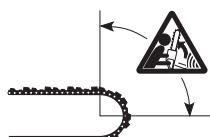
Serrar com a parte inferior da lâmina, ou seja, serrar a partir do lado superior do objecto a ser serrado, e para baixo, chama-se serrar com a corrente a puxar. Então a moto-serra é puxada contra a árvore e o canto anterior do corpo da moto-serra forma um apoio natural contra o tronco. Serração com a corrente a puxar possibilita ao utilizador um melhor controlo sobre a moto-serra bem como sobre onde o sector de risco de retrocesso da lâmina está localizado.
