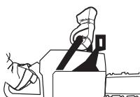
Acelere ao máximo e active o travão de corrente, virando o pulso esquerdo contra a protecção anti-retrocesso. Não solte o punho dianteiro. **A corrente deverá parar imediatamente.**
