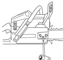
La cadena está correctamente tensada cuando no cuelga en la parte inferior de la espada y puede girarse fácilmente con la mano. Apriete las tuercas de la espada con la llave combinada, sujetando al mismo tiempo la punta de la espada.
