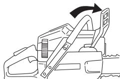
**Ignição; estrangulador:** Ponha o estrangulador na posição de estrangulador. O contacto de paragem irá automaticamente para a posição de arranque.
