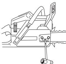
A corrente está correctamente esticada quando não mais estriver frouxa na parte inferior da lâmina e ainda possa ser girada facilmente com a mão. Aperte bem as porcas da lâmina com a chave universal ao mesmo tempo que segura a extremidade da lâmina.
