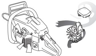
**IMPORTANTE!** Para conservar a função de purificação centrífuga, é necessário prestar assistência e manutenção contínuas. Limpe a entrada de ar do dispositivo de arranque, asas de ventoinha da cambota, compartimento em torno da cambota, tubo de admissão e compartimento do carburador.
