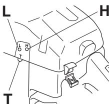
• Con los surtidores L y H se regula la dosificación de combustible deseada para el flujo de aire que permite la abertura del acelerador. La mezcla de aire/combustible se empobrece (menos combustible) girando en el sentido de las agujas del reloj, y se enriquece (más combustible) girando en sentido contrario a las agujas del reloj. El régimen se aumenta con una mezcla pobre y se reduce con una mezcla rica.
