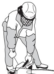
Comprima imediatamente para dentro o estrangulador quando o motor funcionar e faça novas tentativas até que o motor arranque. Quando o motor arrancar dê rapidamente aceleração total e a aceleração de arranque é automaticamente desligada.
