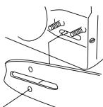
Estique a corrente, apertando com o auxílio da chave universal o parafuso esticador da corrente, no sentido horário. Estique a corrente até que esta deixe de estar frouxa na parte inferior da lâmina. Ver instruções na secção Esticar a corrente da serra.
