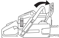
**Encendido; estrangulador:** Ponga el estrangulador en la posición de estrangulamiento. Entonces, el botón de parada se desplazará automáticamente hacia la posición de arranque.
