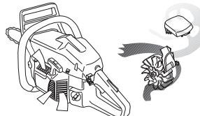
**¡IMPORTANTE!** Para que la depuración centrífuga funcione satisfactoriamente, debe efectuarse un mantenimiento constante del sistema. Limpie la toma de aire del mecanismo de arranque, las palas de ventilador del volante, el espacio alrededor del volante, el tubo de admisión y el compartimiento del carburador.
