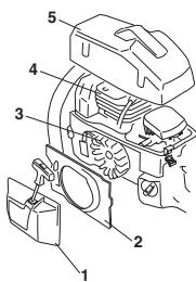
Limpie el sistema refrigerante con un cepillo una vez por semana (en condiciones difíciles, con mayor frecuencia). Un sistema refrigerante sucio u obturado produce sobrecalentamiento de la máquina, con las consiguientes averías del cilindro y el pistón.
