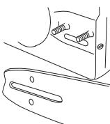
Verigo napnite s kombiniranim ključem tako, da obračate vijak za napenjanje verige v smeri urinega kazalca. Verigo napenjajte toliko časa, da ne bo več ohlapno visela s spodnjega roba meča.
