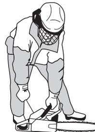
Натиснете смукача веднага след припалване на двигателя и повторете опитите за стартиране. Когато двигателят заработи вие трябва бързо да подадете пълна газ и положението са стартовата газ се изключва автоматично.
