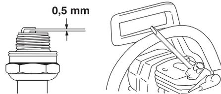
**ЗАБЕЛЕЖКА!** Използвайте винаги запалителните свещи от препоръчания вид! Използването на погрешен тип свещи може да предизвика сериозни повреди на буталото/цилиндъра. Убедете се, че запалителната свещ е снабдена със защита от радиосмущения.
