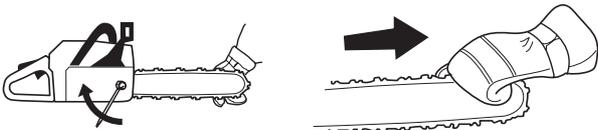
Положението на винта за натягане на триона варира в зависимост от моделите на моторни триони. Вижте инструкциите в раздела Кое какво е, за да откриете къде се намира той при вашия модел.
