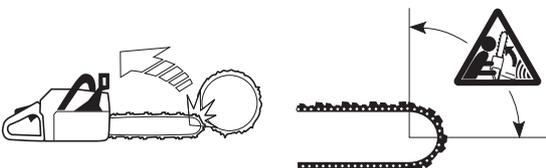
Обратният тласък е винаги в посока на шината. Обикновено верижният трион и шината се отхвърлят назад и нагоре, по посока на оператора. Но верижният трион може да отскочи и в други посоки в зависимост от положението си в момента, когато рисковият сектор на шината се допре до някакъв предмет.
