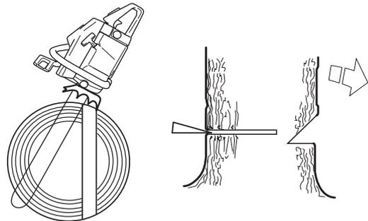
Повалящият срез трябва да завърши успоредно на линията на направляващия срез, като разстоянието помежду им трябва да бъде най-малко 1/10 от диаметъра на стъблото. Несрязаната част на дървото се нарича предпазна ивица.
