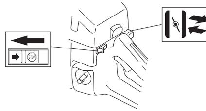
Прилагайте същата начин на стартиране, както при студен двигател, но без да задействате смукача. Положение на стартова газ се получава като задействате смукача и отново го върнете в изходното положение.
