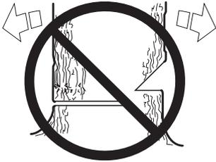
След завършване на повалещия срез и направляващия срез дървото трябва да започне да пада под въздействието на собствената си тежест или с помощта на клин или лост.
