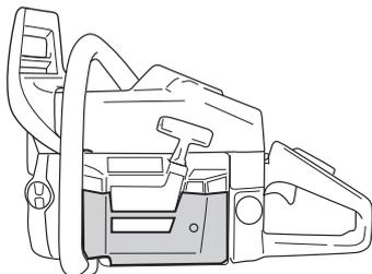
**ВНИМАНИЕ!** Ако е монтиран специален зимен комплект или са взети мерки за повишаване температурата, при използване на машината в нормални температурни условия трябва и регулировка да е нормална. В противен случай съществува опасност от прегряване, което може да доведе до сериозно повреждане на двигателя.
