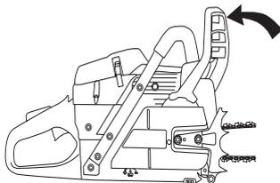
Отвинтете гайките на шината и свалете капака на съединителя. Свалете защитата за транспортиране (А).
