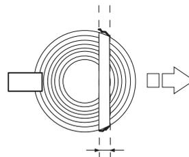
Предпазната ивица е своеобразен шарнир, контролиращ посоката на поваляне на дърво.
