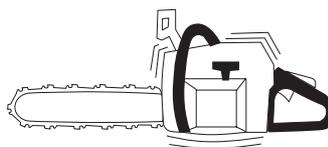
Verifique se os elementos anti-vibração estão fixos entre a parte do motor e a parte dos punhos.
