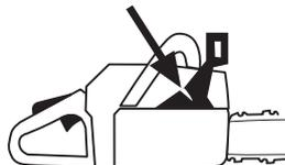
Mova a protecção anti-retrocesso para a frente e para trás, controlando assim se esta funciona a contento e também se está solidamente fixa à sua articulação na cobertura de acoplamento.
