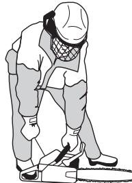
Takojo ko motor poskuša vžgati, potisnite ročico čoka navznoter, nato pa nadaljujte s poskusi, dokler motor ne vžge. Ko motor vžge, hitro dodajte polni plin; zagonski plin se samodejno izklopi.
