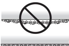
**¡Mantenga el equipo de corte bien lubricado y efectúe el mantenimiento adecuado!** Con una lubricación insuficiente se incrementa el riesgo de roturas de cadena y se aumenta el desgaste de la espada, la cadena y el piñón de arrastre.
