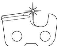
**¡Utilice la profundidad de corte correcta! Siga nuestras instrucciones y utilice el calibrador de profundidad de corte recomendado.** Una profundidad de corte demasiado grande aumenta el riesgo de reculada.
