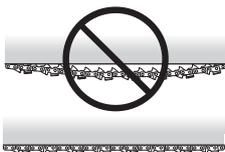
**Sorgen Sie für eine gute Schmierung und Wartung der Schneidausrüstung!** Wenn die Sägekette unzureichend geschmiert wird, erhöht sich die Gefahr, dass sie reißt. Zudem werden Führungsschiene, Sägekette und Kettenantriebsrad stärker abgenutzt.
