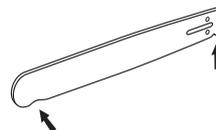
Para obter vida útil máxima, a lâmina deve ser virada diariamente.
