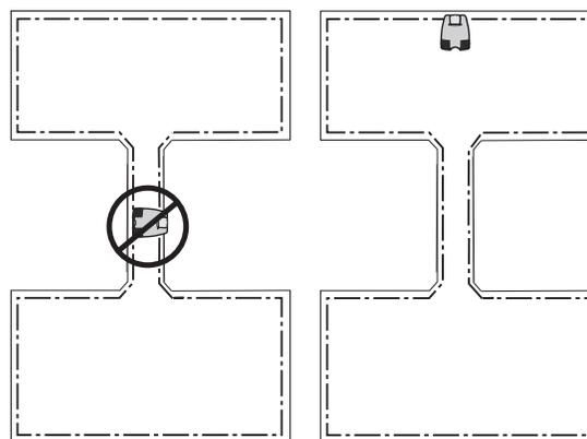
Ne placez pas la station de charge de manière à ce que la tondeuse puisse venir à moins de 10 ft (3 mètres) derrière la station de charge (par exemple un coin). La tondeuse ne trouverait pas la station de charge.
