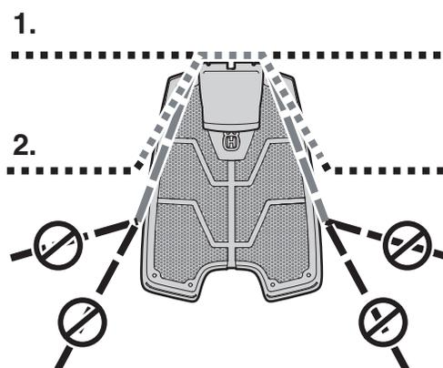
Pour connecter le câble périphérique sur la station de charge, enfoncez l'extrémité de câble droit dans le trou de droite et l'extrémité de câble gauche dans le trou de gauche.
