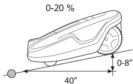
Le câble périphérique ne doit pas être posé en travers d'une pente d'une inclinaison supérieure à 20 %. Automower® aurait du mal à tourner. La tondeuse s'arrête et affiche le message d'erreur *En dehors zone de tonte*. Le risque est particulièrement important par temps humide dans la mesure où les roues risquent de dérapier dans l'herbe mouillée.
