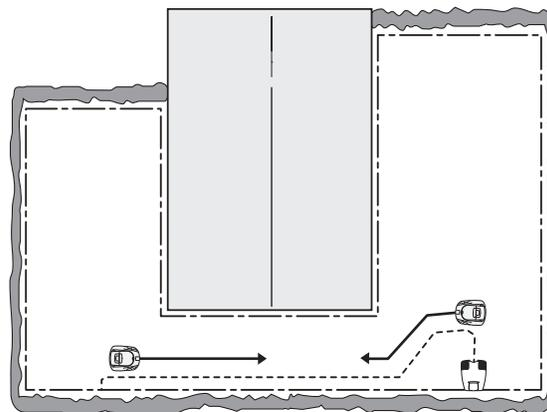
Évitez de placer le câble dans des angles pointus. La tondeuse risquerait d'avoir du mal à suivre le câble guide.
