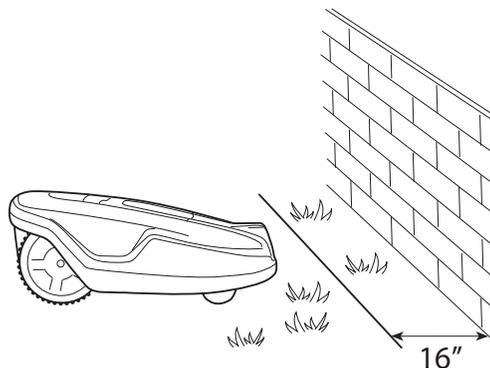
Si la zone de travail est délimitée par un petit fossé, une plate-bande par exemple, ou une petite surélévation, un rebord en pierres basses par exemple (1" - 2") (3 à 5 cm), le câble périphérique doit être placé à 14" (35 cm) à l'intérieur de la zone de travail. De cette manière, les roues ne risquent pas de basculer dans le fossé ou de monter sur le rebord.
