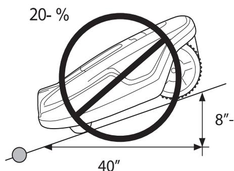
Par contre, s'il existe un obstacle contre lequel Automower® peut être autorisée à buter, par exemple une clôture ou une haie touffue, le câble périphérique peut être posé en travers d'une pente d'une inclinaison supérieure à 20 %.
