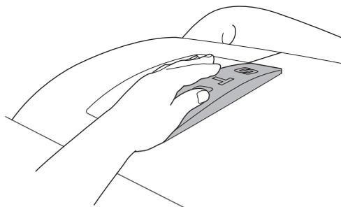
2. Mettez l'interrupteur sur *OFF* si la tondeuse doit être déplacée.
