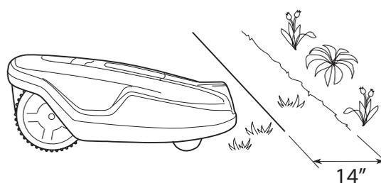
Si la zone de travail est contiguë à une allée au même niveau que la pelouse, il est possible de laisser Automower® s'avancer quelque peu sur cette allée. Le câble périphérique doit être placé à 4" (10 cm) du bord de l'allée.
