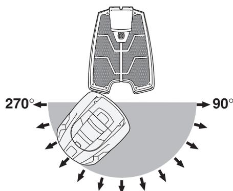
Der Mäher kann für einen oder zwei Ausfahrtsektoren eingestellt werden. Befindet sich die Ladestation in einer Passage, können zwei Ausfahrtsektoren von z. B. 70°-110° und 250°-290° erforderlich sein.
