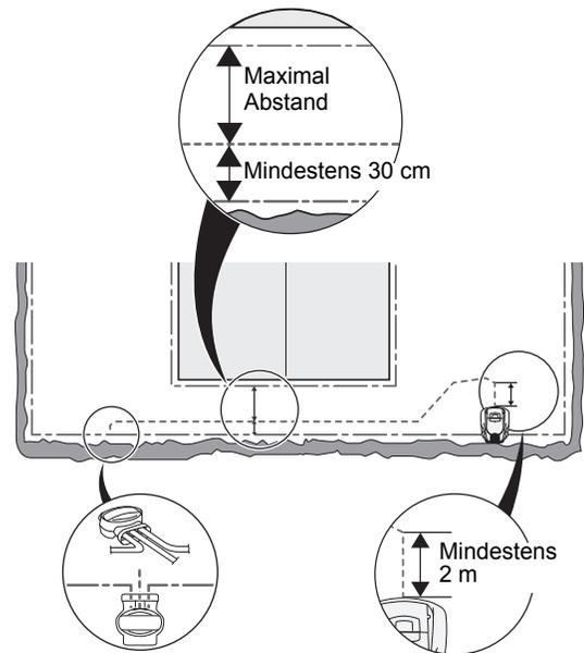
Bei der Verlegung des Suchkabels durch eine Passage:
