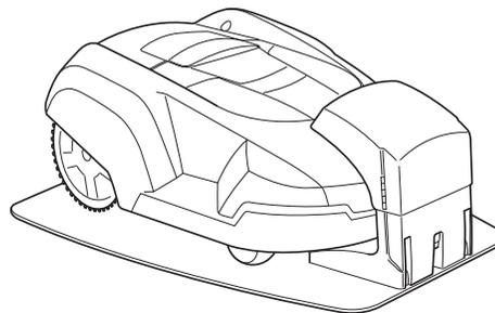
Ein guter Kontakt entsteht, wenn beide Ladebleche des Mähers mittig an den Kontaktblechen der Ladestation anliegen.
