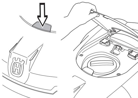
3. Den Drehknopf in die gewünschte Position stellen. Die gewählte Position ist die Markierung am Drehknopf, die sich vor dem Pfeil am Gehäuse befindet.
