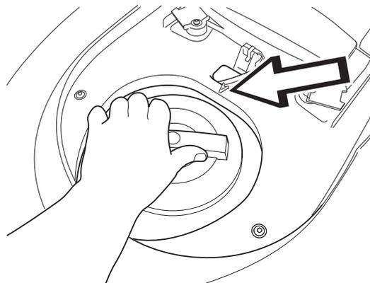
4. Abdeckung schließen. Sicherstellen, dass der Sperrknopf einrastet.
