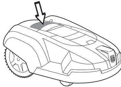
Die Bedientafel besteht aus einem Display und einer Tastatur. Alle Informationen werden auf dem Display angezeigt, und alle Eingaben werden mit den Tasten vorgenommen.
