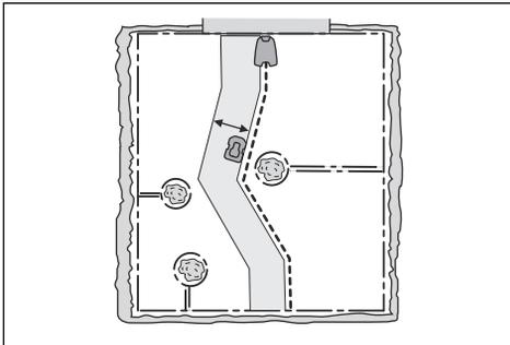
Die Korridorbreite wird automatisch eingestellt. Wenn die Korridorbreite manuell angepasst werden muss, damit das Gerät ordnungsgemäß funktioniert, können Sie die Korridorbreite zwischen 0-9 einstellen. Wenn die Korridorbreite des Leitkabels auf 0 eingestellt ist, überfährt das Gerät das Leitkabel. Die Werkseinstellung ist 6 für das Begrenzungskabel und 9 für das Leitkabel.
