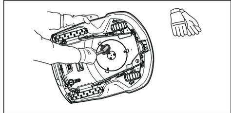
9. Um das Gehäuse des Geräts zu installieren, legen Sie es auf das Chassis und drücken es hinein.
