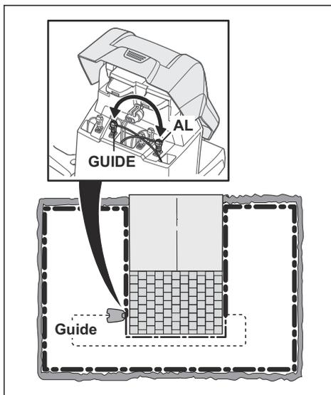
Zur Behebung des Fehlers benötigen Sie Begrenzungskabel, Anschlussklemme(n) und Verbinder:
