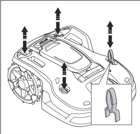
5. Drücken Sie das Wartungswerkzeug in einer der 4 Positionen nach unten, und ziehen Sie das Gehäuse nach oben.
