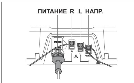
3. Поменяйте местами соединения направляющего и ограничительного проводов в зарядной станции.
