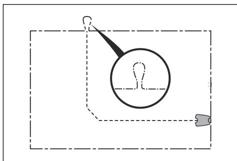
**Примечание:** Перед прокладыванием ограничительного и направляющего проводов составьте схему рабочей зоны.
