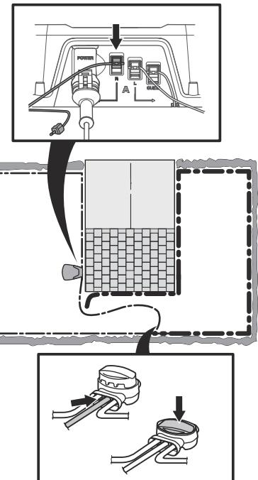
Если индикаторная лампа теперь мигает желтым светом, это означает, что обрыв находится где-то на участке провода между отсоединенными концами и местом, где подсоединен новый провод (жирная черная линия ниже). В этом случае переместите соединение нового кабеля ближе к отсоединеному концу (примерно посередине того участка, где, на ваш взгляд, произошел разрыв) и проверьте снова, горит ли контрольная лампа зеленым светом.
