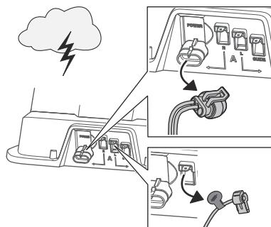
Для снижения риска повреждения электрических компонентов изделия и зарядной станции мы рекомендуем отсоединить все подключенные к зарядной станции элементы (источник питания, ограничительный и направляющий провода), если ожидается гроза.
