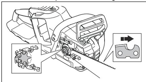
6. Montare il coperchio del pignone guida e inserire il fermo tendicatena nel foro sulla barra di guida.
