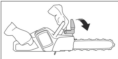
3. Inserire la batteria nel relativo supporto.
