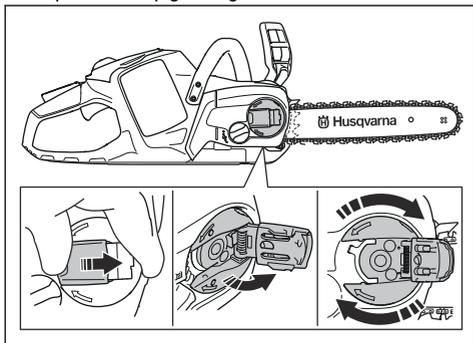
2. Sollevare la parte anteriore della barra di guida e girare il ruotino tendicatena. Serrare la catena fino a quando è serrata contro la barra di guida.
