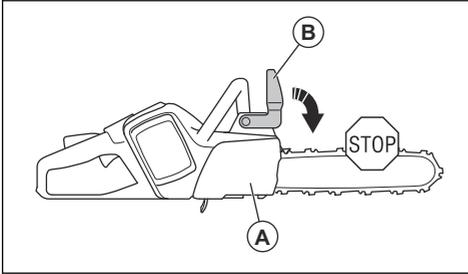
Il modo in cui il freno della catena viene innestato è correlato alla forza del contraccolpo e alla posizione del prodotto. In caso di intenso contraccolpo mentre il relativo settore è quello più lontano dall'operatore, il freno della catena viene innestato dal meccanismo inerziale. Se il contraccolpo è leggero e il settore di contraccolpo è più vicino all'operatore, il freno della catena viene innestato manualmente con la mano sinistra.
