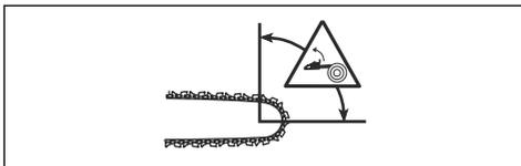
Il freno della catena (A) si attiva manualmente con la mano sinistra o in automatico con il meccanismo di attivazione inerziale. Spingere la protezione anticcontraccolpo (B) per inserire manualmente il freno
