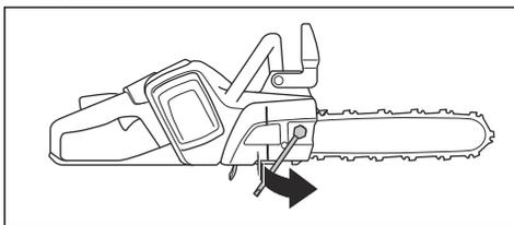
2. Sollevare la parte anteriore della barra di guida e girare la vite tendicatena. Servirsi della chiave universale.
