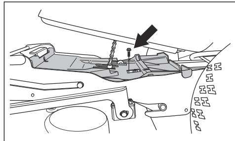
3. Разхлабете гайките на пръта за повдигане.
