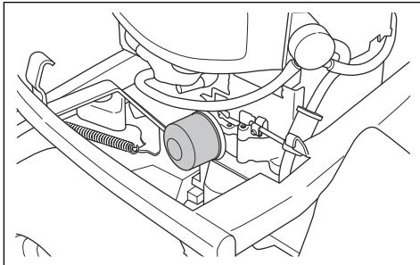
11. Lubrificați usor garnitura din cauciuc de pe noul filtru de ulei, utilizând ulei nou.
