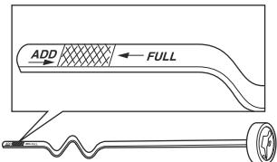
8. Оліву слід заливати крізь отвір, в якому встановлюється вимірювальний стрижень. Заливайте повільно.
