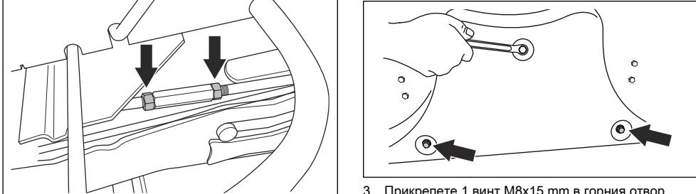
3. Прикрепете 1 винт M8x15 mm в горния отвор за винтове на BioClip запушалката, за да предотвратите повреждане на резбите.
