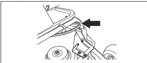
9. Установите деревянный брускок между рамой оборудования и шасси. Это позволит избежать отскакивания режущей деки при снятии.
