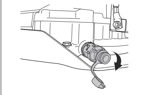
3. Поставете пластмасов маркуч на края на изпускателната пробка за масло, за да предотвратите разливане.
