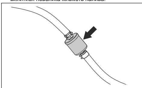
5. Вставте новий паливний фільтр у кінці шлангів. Нанесіть рідкий миючий засіб на кінці паливного фільтра, щоб полегшити з'єднання.
