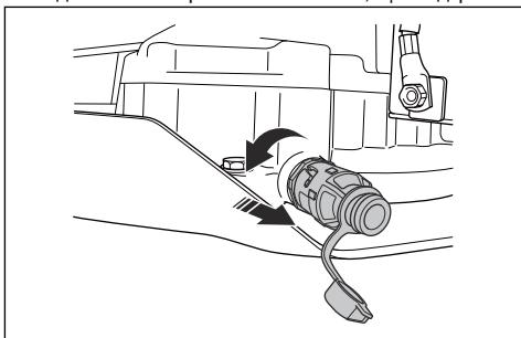
5. Вийміть вимірювальний стрижень.
