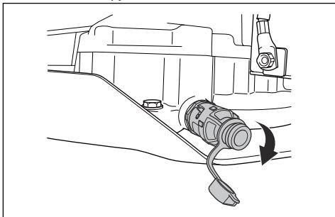
3. Прикріпіть пластиковий шланг до кінця пробки зливного отвору, щоб запобігти розливанню оліви.
