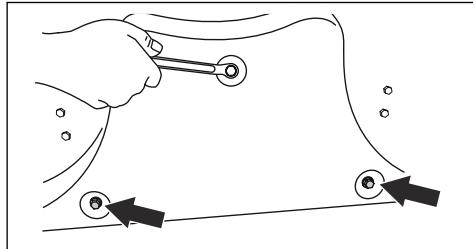
3. Заверните 1 винт M8x15 мм в резьбовое отверстие для заглушки BioClip, чтобы избежать повреждения резьбы.
