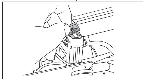
3. Замініть перегорілій запобіжник новим запобіжником такого ж типу, плаский штир 15 А.
