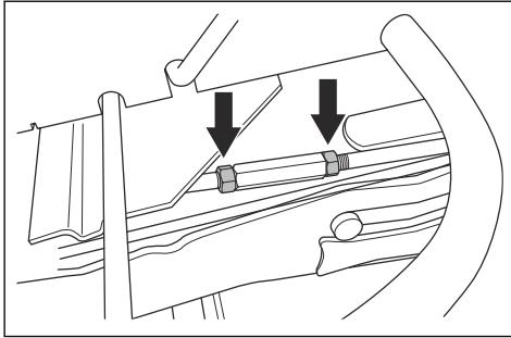
4. Въртете пръта за повдигане, за да удължите или съсътите опората. Удължете опората за повдигане на задния ръб на капака. Съсътете я, за да спуснете задния ръб на капака.
