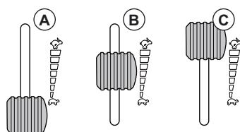
**Зверніть увагу:** Зчеплення лез за максимальною частотою обертання двигуна призводить до розтягування приводних пасів. Не відкривайте дросельну заслінку повністю, доки різальну деку не буде опущено до положення скочування.
