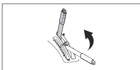
Для опускания режущей деки в рабочее положение нажмите кнопку блокировки и переместите рычаг подъема вперед. Если двигатель включен, ножи автоматически начнут вращаться.
