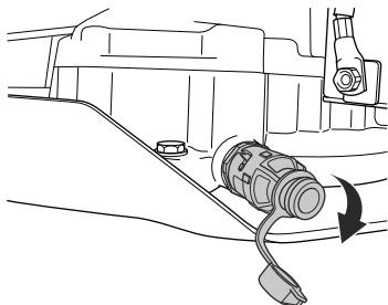
3. Подсоедините пластмассовый шланг к концу сливной пробки, чтобы предотвратить проливание.
