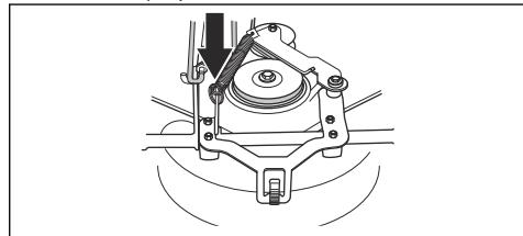
7. Поставете върха на пружината в държача върху рамото за опъване на задвижващия ремък.
