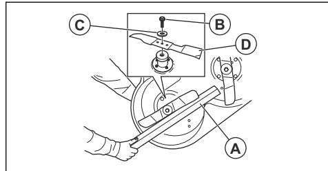
3. Ослабьте и снимите болт ножа (B), шайбы (C) и нож (D).
