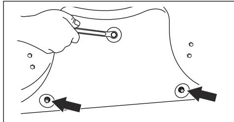
3. Установіть 1 гвинт M8 x 15 мм у верхній отвір на заглушці BioClip, щоб запобігти пошкодженню різьбових поверхонь.
