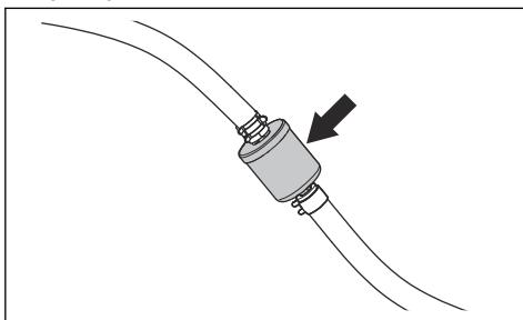
5. Вставьте новый топливный фильтр в концы шлангов. Нанесите жидкое мыло на края топливного фильтра, чтобы упростить соединение.
