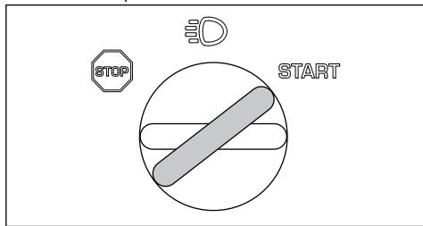
**Примечание:** Не включайте стартер более чем на 5 секунд за раз. Если двигатель
