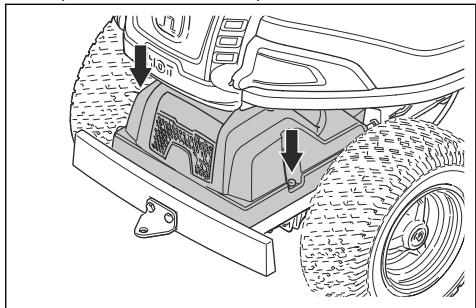
3. Уверете се, че нивото на маслото в резервоара за масло на трансмисията е между 2 хоризонтални линии върху резервоара.
