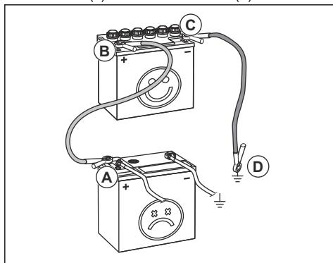
4. Conectați celălalt capăt al cablului roșu la borna POZITIVĂ (+) a bateriei complet încărcate (B).
