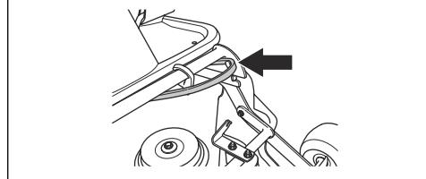
9. Установіть дерев'яний брускок між рамою обладнання й шасі. Це потрібно, щоб різальна дека не відскочила під час демонтажу.
