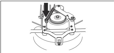
7. Поместите ушко пружины в держатель на рычаге регулировки натяжения приводного ремня.
