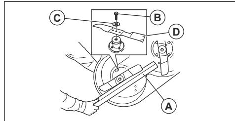
3. Відкрутіть і витягніть болт леза (B), шайби (C) та лезо (D).
