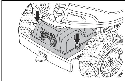
3. Asigurați-vă că nivelul uleiului din rezervorul de ulei de transmisie se află între cele 2 linii orizontale de pe rezervor.
