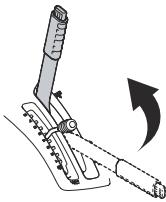
Pentru a cobori capul tăietor în poziția de tunz gazonul, apăsați butonul de blocare și deplasați pârghia de ridicare în față. Dacă motorul este pornit, rotația cuțitelor pornește automat.
