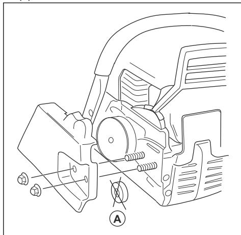
**Примечание:** Если кожух сцепления сложно снять, затяните гайку крепления шины, включите тормоз цепи, а затем выключите его. При правильном выключении вы услышите щелчок.
