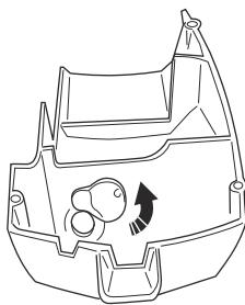
3. Для работы при температуре ниже -5°C/23°F или в условиях снегопада доступны зимняя крышка (A) и зимняя заглушка (B). Установите зимнюю крышку (A) с зимней заглушкой (B) на корпус стартера. Зимняя крышка уменьшает поток холодного воздуха и не дает снегу попасть в пространство карбюратора.
